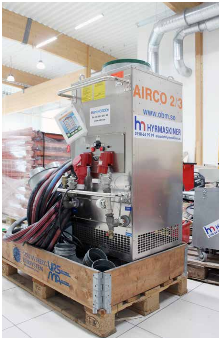
Ett tork- och värmeaggregat med möjlighet att koppla direkt till fjärrvärmn.
