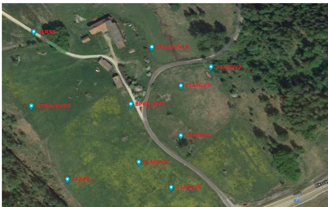
Figur 9. Översiktsbild med placering av grundvattenrör. I gällande undersökning har grundvatten från 21AFGV2, 21AFGV3, 21AFGV5, 21AFGV6, GV2, GV03, GV14, 21R59 och 21R51 analyserats.
