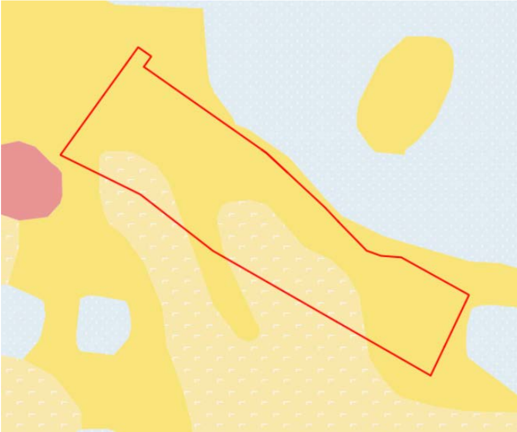
SGU Jordartskarta. Gul är glacial lera och ljusgul med vita streck är postglacial finlera.
